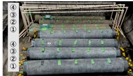
手前：2m電柱、① 0.25mm 圧縮ひび割れ導入管、② 0.05mm 圧縮ひび割れ導入管、③0.10mm 曲げひび割れ導入管、④健全管、奥側：ヒューム管、① 健全管、② 0.10mm 曲げひび割れ導入管、③0.05mm 圧縮ひび割れ導入管、④0.25mm 圧縮ひび割れ導入管
