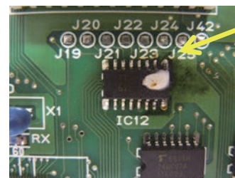
図2. 雷サージが電子装置の基盤に侵入しICが破損した例
