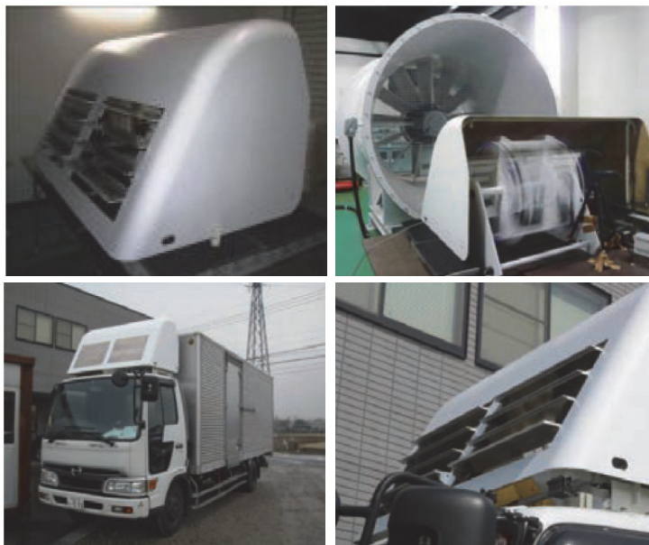
図1. 車載用風力発電導入型デフレクタ
