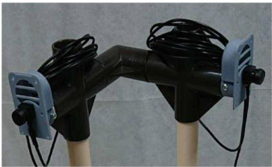
Fig. 4 2台の魚眼カメラによる撮影システム
