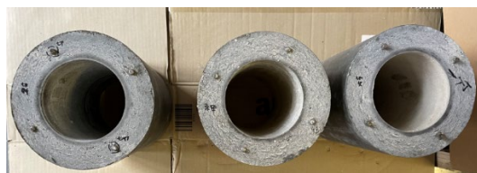
図 1c 作成した円柱供試体（RC 構造）
