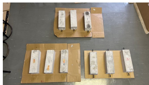
図 1b 作成した角柱供試体（RC 構造）
