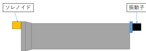
図2 ソレノイドを用いた劣化診断実験装置配置図
