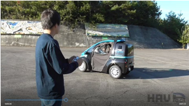
図 2：遠隔操縦による小型電気自動車制御の様子
