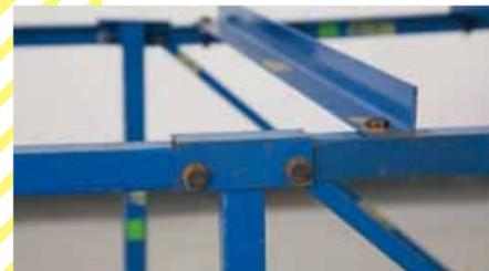
使用するネジを1種類にして、組み立て時間を短縮
