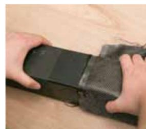
強度&軽量化のため、骨組みはカーボン製
