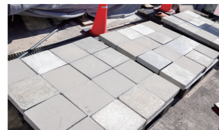
▲コンクリートに加える混和剤の種類や量を変化させ、どのような性質変化があるかを実験。
