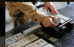
◀コンクリートの材料となる素材の配合を変え、酸に対する反応を見る。地味な作業だが、この組み合わせから最適解を探っていく。
