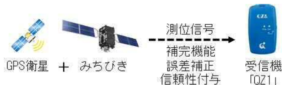
図 1 準天頂衛星の測位信号の受信システム
